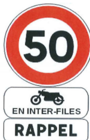
Illustration 16 – Le signal de limitation de vitesse B14 et ses panonceaux relatifs à la circulation inter-files
